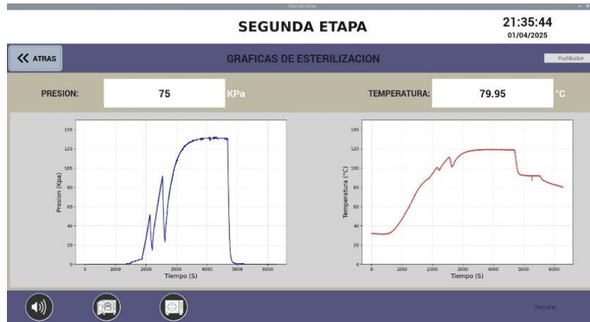
Figura 3.5. Grafica final del ciclo de esterilización.
