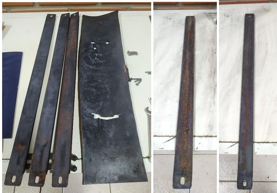
Figura 2.4. Estado de resistencias eléctricas
